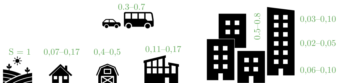
Slika 6.1 | Shematski prikaz faktorja zaradi ščitenja glede na različno vrsto zgradb.
