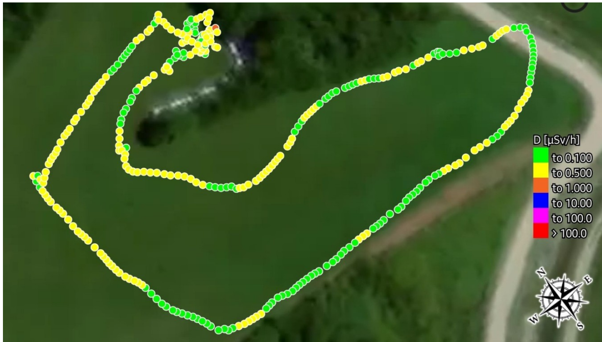
Slika S1b: Prikaz rezultatov meritve hitrosti okoljskega doznega ekvivalenta na obhodni poti na Vrbinju pri izvajanju primerjalnih meritev hitrosti okoljskega doznega ekvivalenta na 10 izbranih merilnih mestih (posnetek ZVD; slika je glede na sliko S1a zavrtena za 90° v pozitivni smeri).
