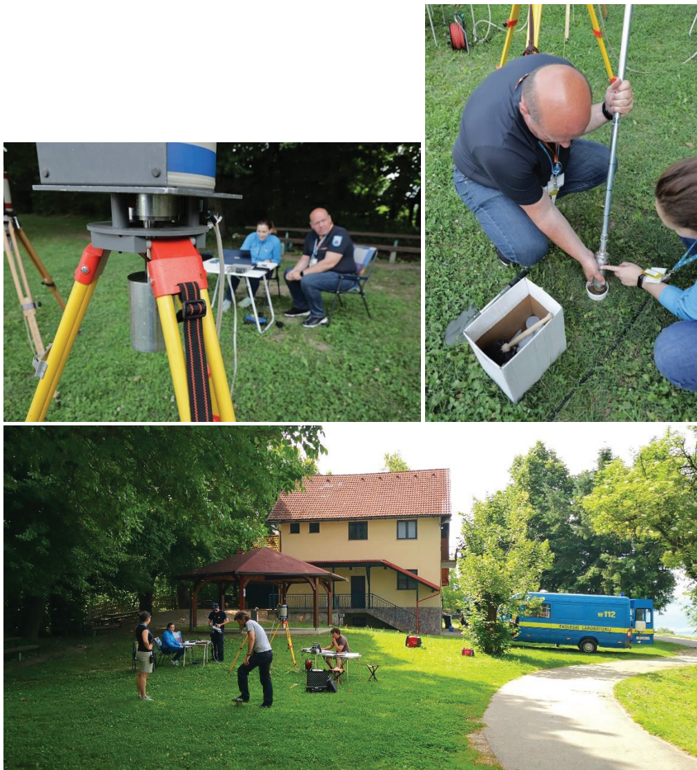
Slika 7: Izvajanje spektrometrije gama in-situ ter vzorčenje zemlje za naknadno meritev v mobilnem laboratoriju
