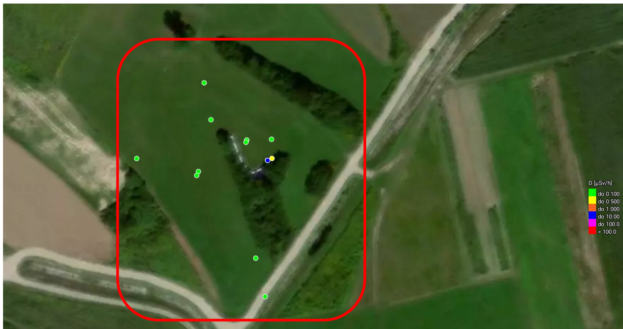
Slika S1a: Prikaz območja na Vrbini, kjer so potekale meritve spektrometrije gama in-situ, vzorčevanje zemlje na terenu, primerjalne meritve aktivnosti ter hitrosti okoljskega doznega ekvivalenta na 10 merilnih mestih in meritve meteoroloških parametrov (posnetek IJS ELME).
