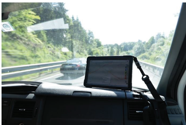
Slika 1: Izvajanje meritev mapiranja hitrosti doz iz vozečega vozila
