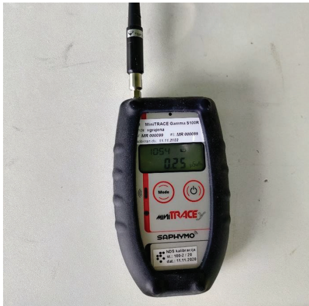
Slika 15: Vključitev merilnikov hitrosti doz gama Saphymo miniTRACE v sistem NEK
