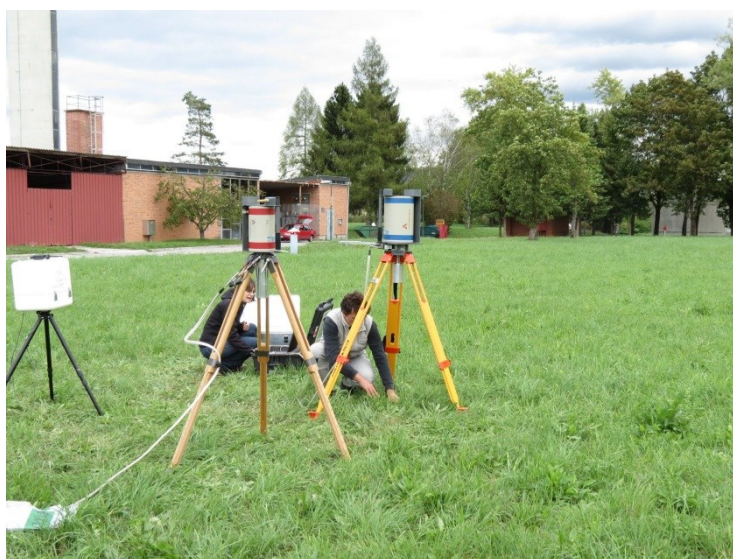
Slika 7: In-situ spektrometrija gama na zahodni strani reaktorja v okviru vaje in primerjalnih meritev med tremi različnimi laboratoriji, 18.9.2013
