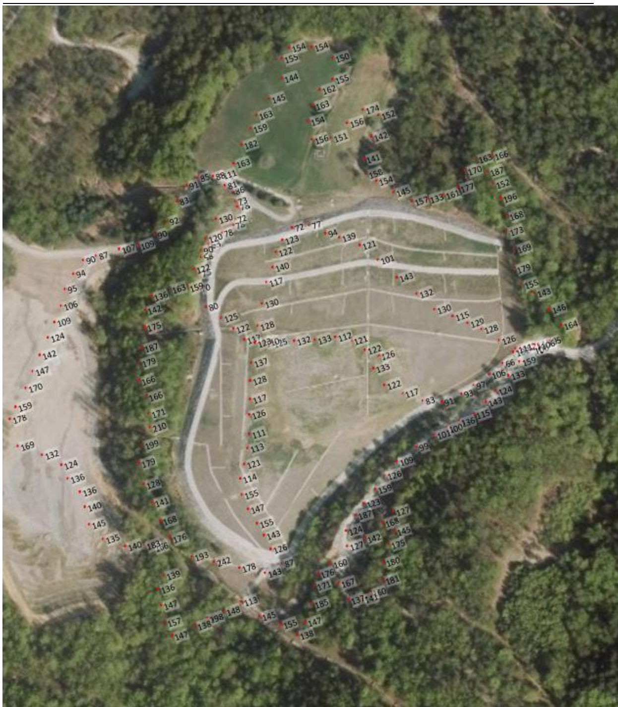
Slika 21: Meritve hitrosti doze ( \mu\text{Sv/h} ) – letalski posnetek
