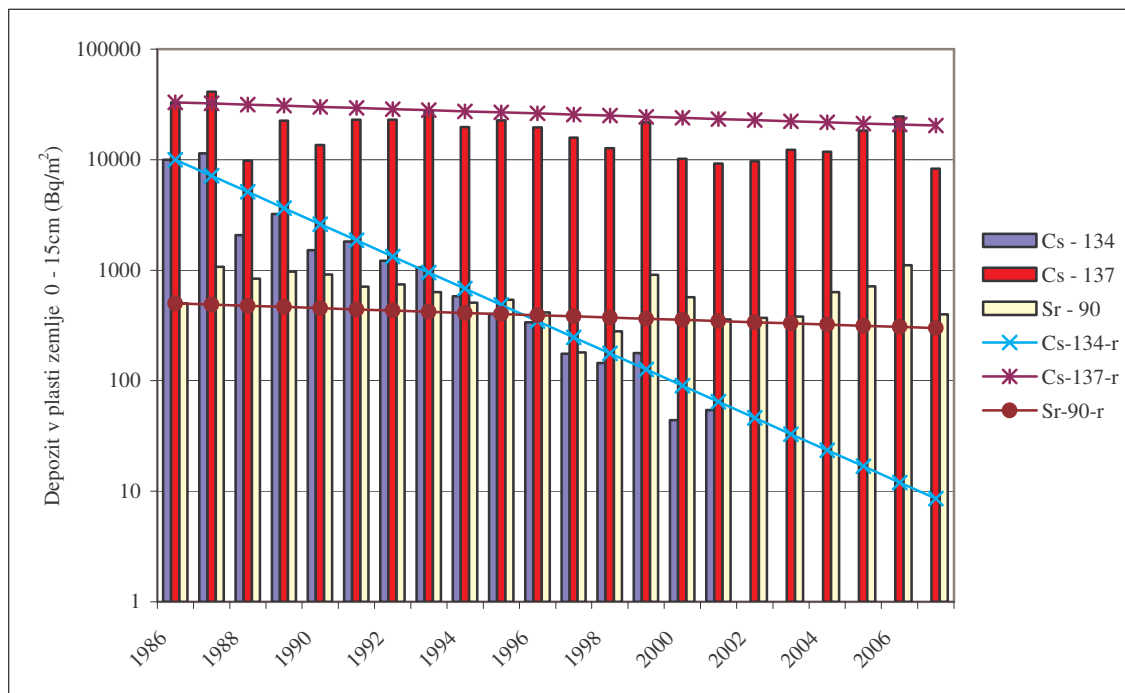
Slika 20: Specifične aktivnosti – depozit 134 Cs, 137 Cs in 90 Sr v plasti 0-15 cm za Kobarid, 1986 – 2007
