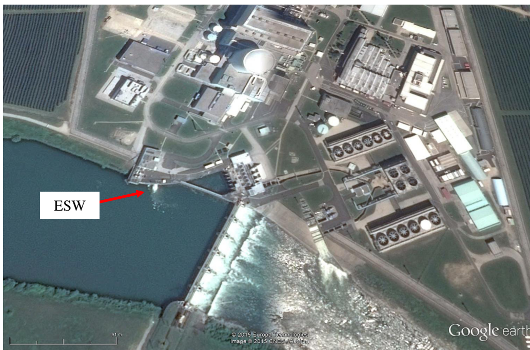
Slika 2.1: Satelitski posnetek NEK – označen je izhod bistvene oskrbne vode (ESW), kjer se izpuščajo radioaktivne tekočine.
