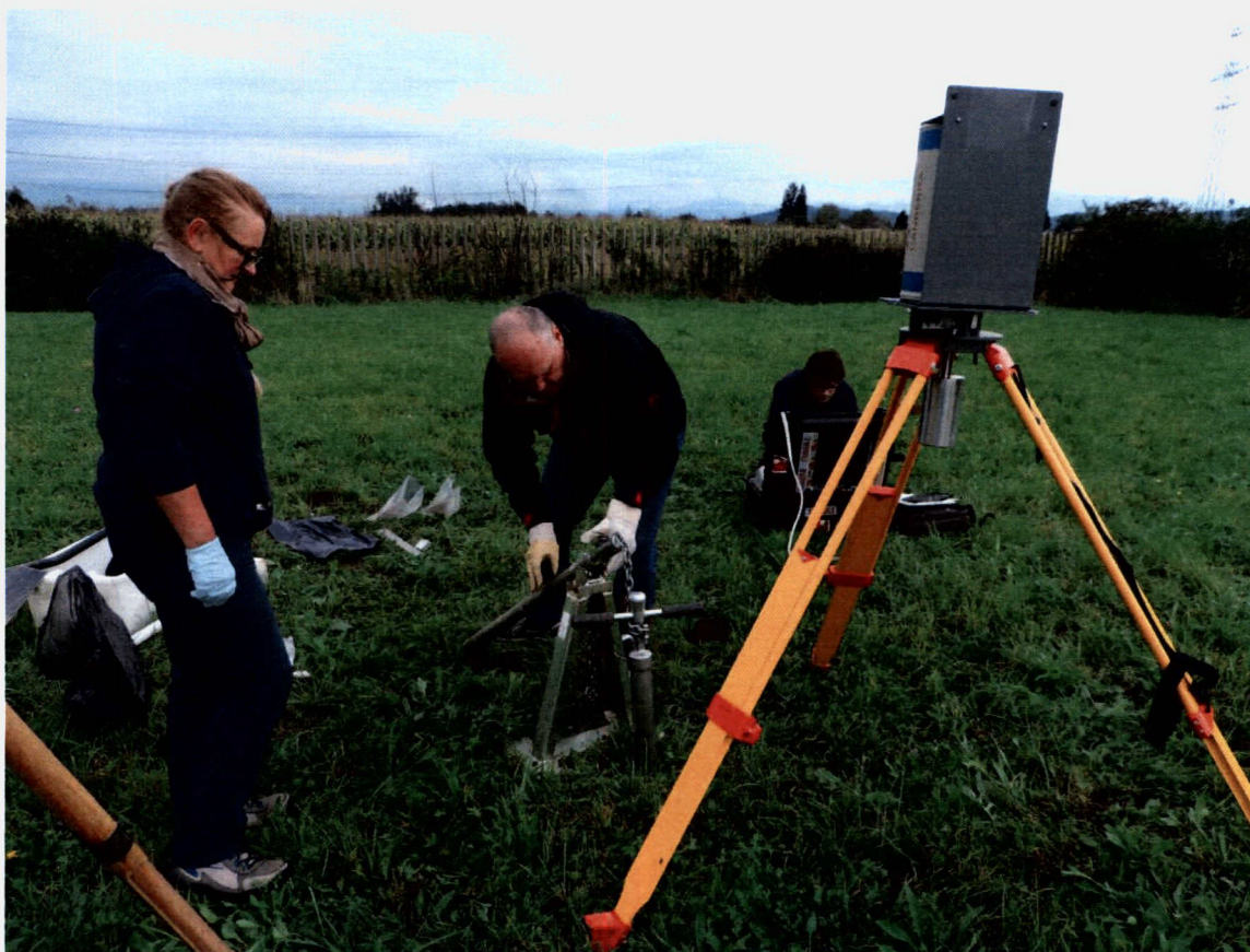
Slika 7: Spektrometrija gama in-situ in vzorčenje zemlje na severovzhodni strani reaktorja v okviru vaje in primerjalnih meritev med različnimi slovenskimi in hrvaškimi laboratoriji, 21.9.2016
