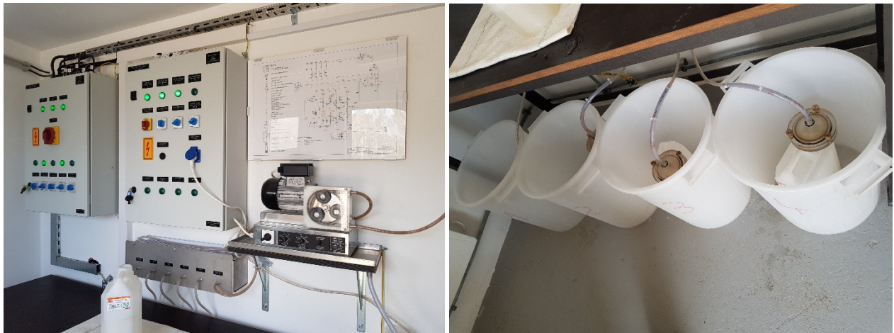
Slika 1.3: Avtomatska vzorčevalna postaja HE Brežice (7,2 km nizvodno od NEK), kjer poteka neprekinjen zajem vzorcev vode
