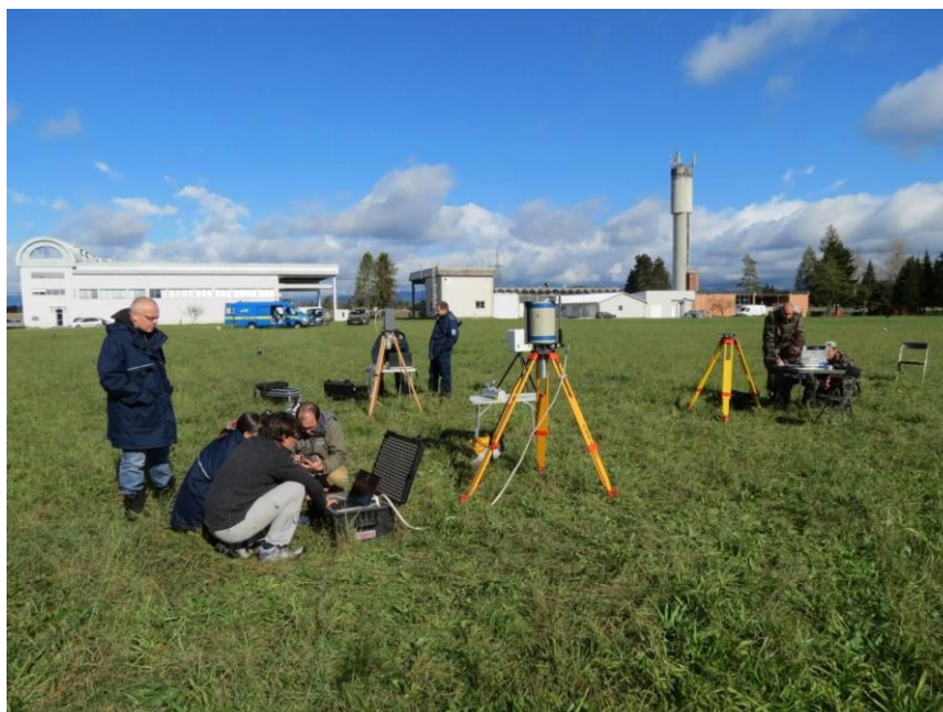
Slika 7: Spektrometrija gama in-situ na zahodni strani reaktorja v okviru vaje in primerjalnih meritev med tremi različnimi laboratoriji, 22.10.2014
