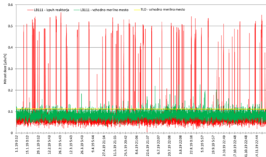
Slika 6: Hitrost doze na vzhodni merilni točki in na izpuhu v letu 2019 – kontinuirni merilnik Berthold LB111 in TLD (Oznaka: 1.6HD)
