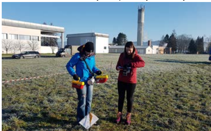
Slika 7: Meritve hitrosti doze v okviru vaje in primerjalnih meritev med različnimi slovenskimi in hrvaškimi laboratoriji, 17. 9. 2019
