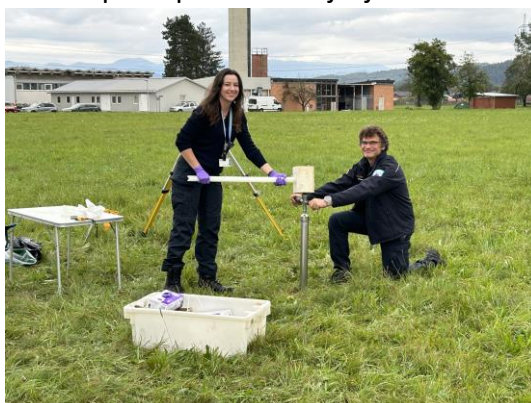
Slika 7: Vzorčenje zemlje na mestu In-Situ meritev Z od reaktorja, 4. 10. 2023
