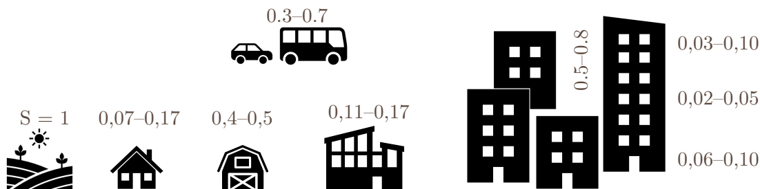
Slika 7.1 | Shematski prikaz faktorja zaradi ščitenja glede na različno vrsto zgradb.
