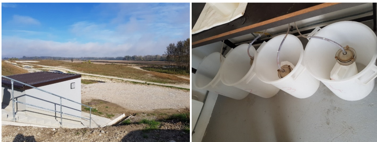
Slika 1.3: Nova avtomatska vzorčevalna postaja HE Brežice (7,2 km nizvodno od NEK), kjer poteka kontinuirni zajem vzorcev vode
