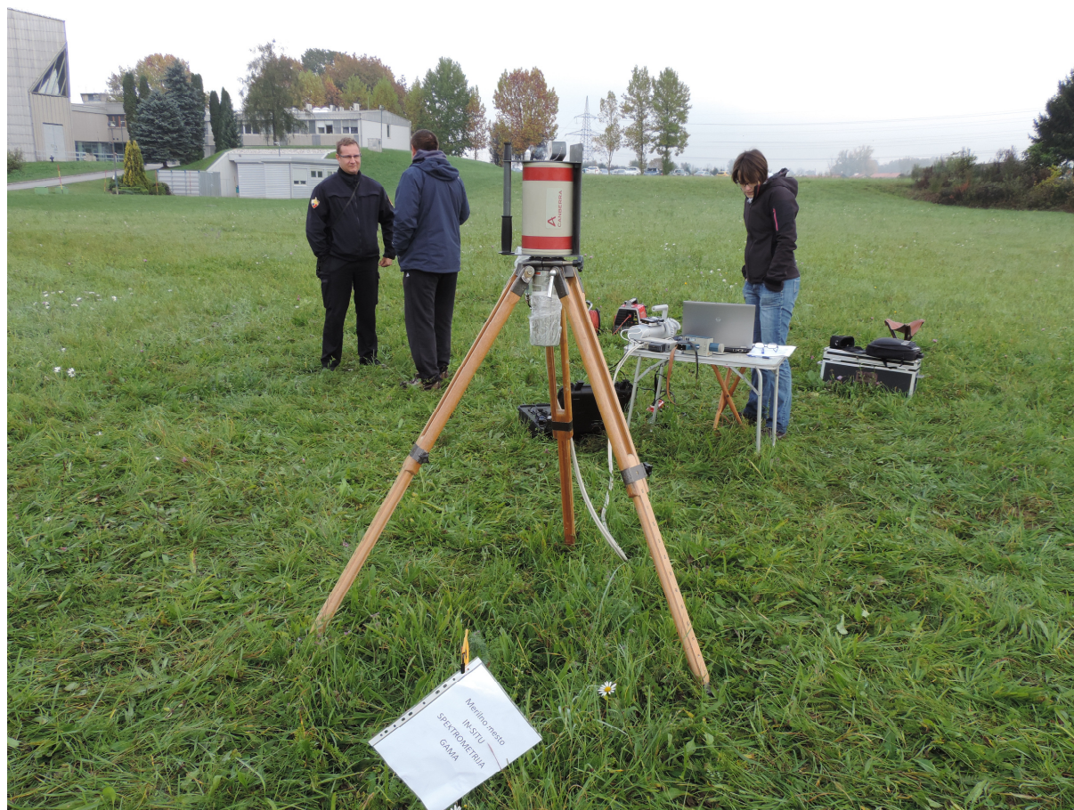
Slika 7: Spektrometrija gama in-situ na zahodni strani reaktorja v okviru vaje in primerjalnih meritev med tremi različnimi laboratoriji, 21.10.2015
