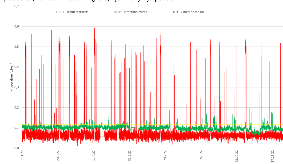
Slika 7: Hitrost doze na vzhodni merilni točki in na izpuhu v letu 2022 – kontinuirna merilnika Berthold LB111 in MFM ter TLD (Oznaka: 1.6HD)
