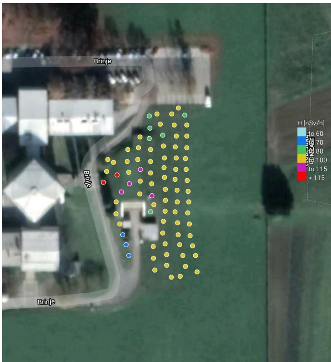
Slika 2: Rezultati meritev hitrosti doze H^*(10) [nSv/h] sevanja gama v ožji in širši okolici objekta CSRAO, predstavljeni s programsko opremo Route Monitoring (september 2021)
