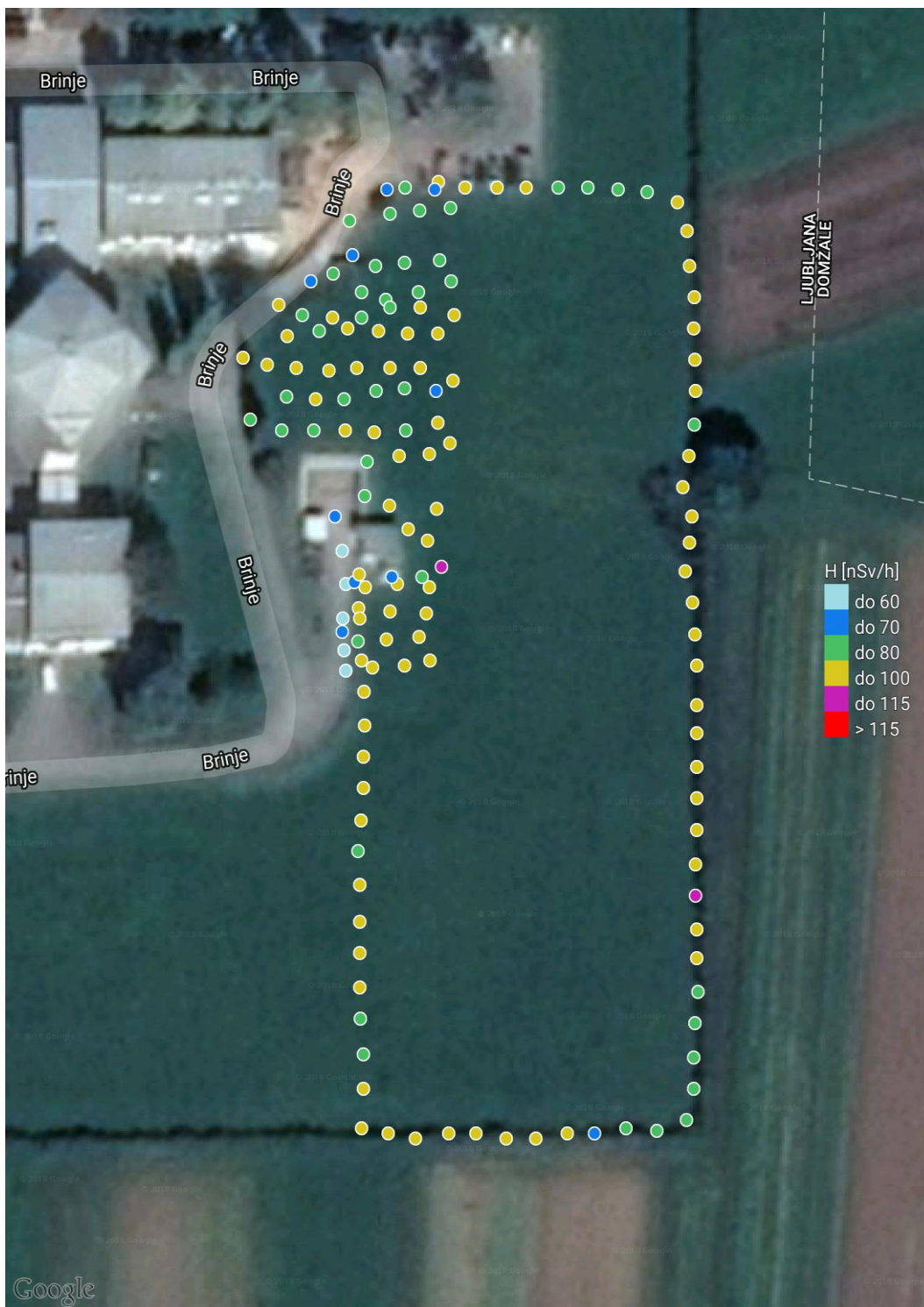
Slika 3: Rezultati meritev hitrosti doze H^*(10) [nSv/h] sevanja gama v ožji in širši okolici objekta CSRAO, predstavljeni s programsko opremo RouteMonitoring (maj 2017).
