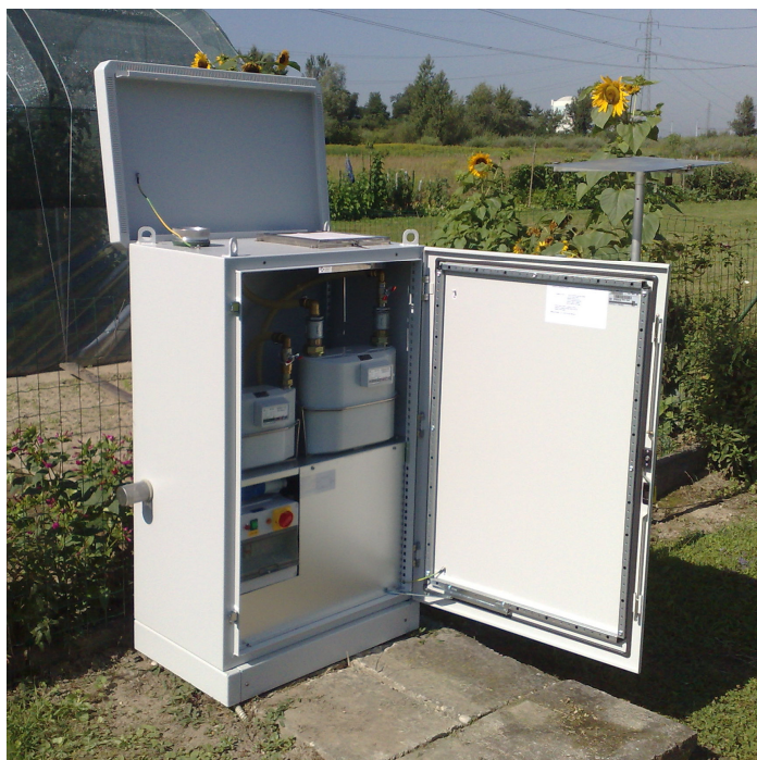
Slika 4.2: Kombinirana zračna črpalka IIS na lokaciji Spodnji Stari Grad. Gre za tipsko črpalko, ki je tudi na drugih lokacijah v okolici NEK. V letu 2015 je bilo izvedeno prvo ocenjevanje hrupa merilne naprave, ki jo je izvedlo podjetje Epi Spektrum varstvo okolja, informacijski sistemi in storitve, d. o. o. Na podlagi meritev hrupa in modelnega izračuna je bilo ocenjeno, da obremenitev s hrupom zaradi obratovanja vzorčevalnika zraka pri najbližjih stavbah z varovanimi prostori ne presega mejnih vrednosti za vir hrupa in mejnih koničnih vrednosti kazalcev hrupa za obrat ali napravo.
