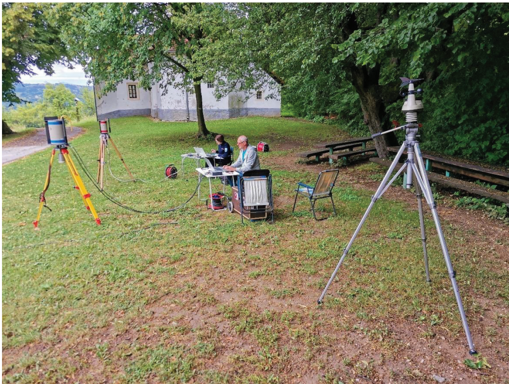
Slika 7: Izvajanje spektrometrije gama in-situ ter vzorčenje zemlje za naknadno meritev v laboratoriju
