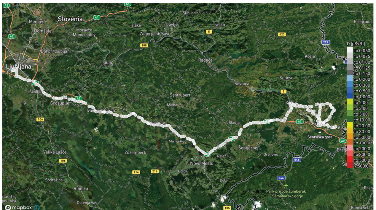
Slika S5b: Kartiranje hitrosti okoljskega doznega ekvivalenta na poti od Ljubljane do okolice Krškega vključno z obhodom desetih točk, določenih iz strani URSJV (meritve IJS ELME-03, merilnik Automess s scintilacijsko sondo)
