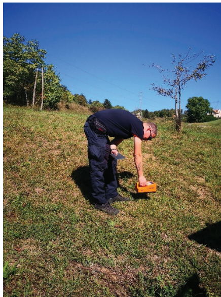
Slika S3: Meritve hitrosti okoljskega doznega ekvivalenta in površinske kontaminacije na različnih lokacijah, prvi dan obhoda.
