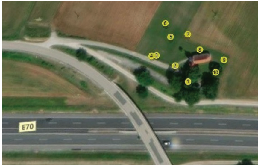
Slika S1a: Prikaz območja pri cerkvi Sv. Urha na Vihrah, kjer so potekale meritve spektrometrije gama in-situ, vzorčenje zemlje na terenu, primerjalne meritve aktivnosti ter hitrosti okoljskega doznega ekvivalenta na 10 merilnih mestih in meritve meteoroloških parametrov (posnetek IJS ELME).
