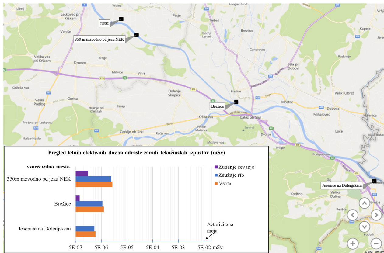
Slika P1: Pregled ocenjenih letnih efektivnih doz za umetne radionuklide za tekočinske izpuste iz NEK v letu 2020. Skala na legendi je logaritemska.
