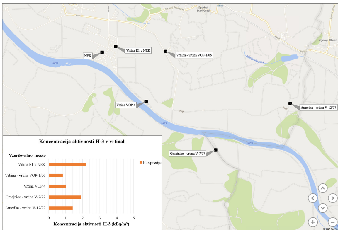
Slika I6: Pregled povprečnih mesečnih koncentracij aktivnosti H-3 v vodi iz vrtin v okolici NEK. Voda iz vrtin se ne uporablja niti kot pitna voda niti kot tehnološka voda, ampak le za sledenje izpustov iz NEK.
